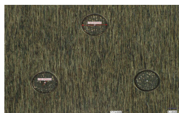
ザグリ孔加工 材質：モリブデン 開口部：9 μm 座ぐり深さ：35 μm 応用分野：基礎研究、半導体マイクロエレクトロニクス
